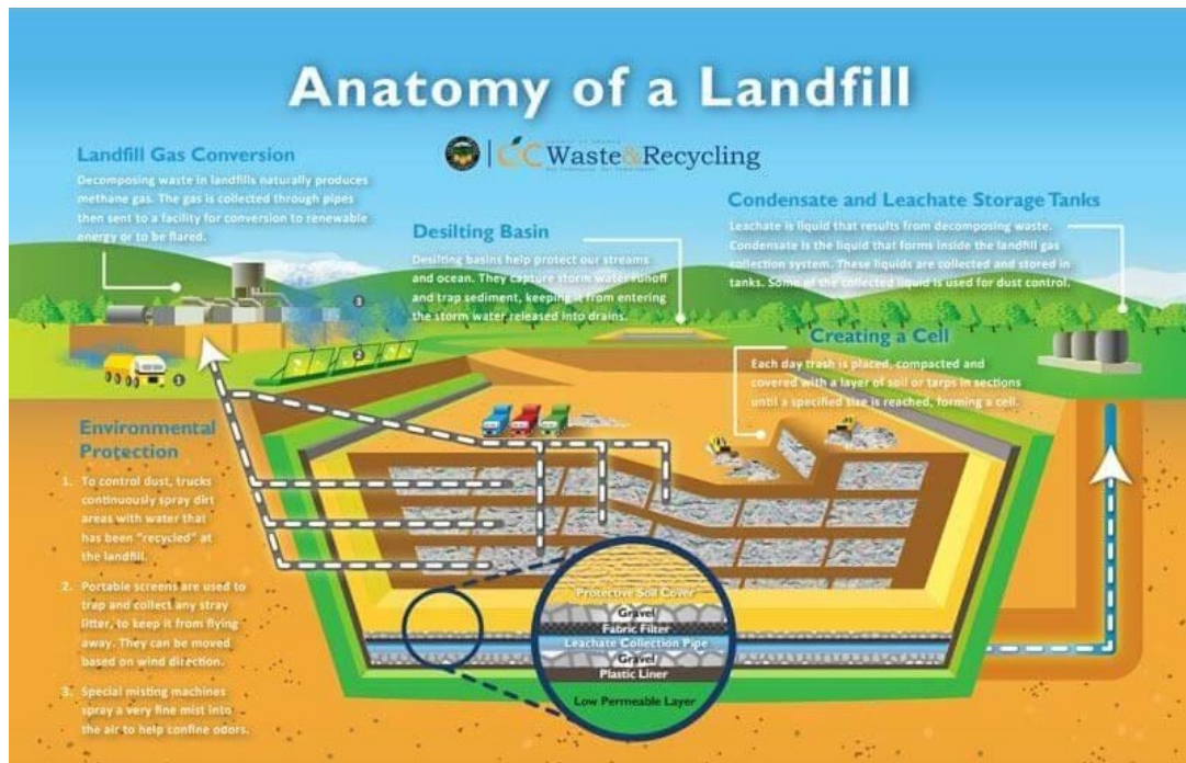
Figura 10: Sección transversal típica de un vertedero sanitario moderno (Fuente: https://www.baltimorecountymd.gov/departments/publicworks/recycling/theresource/today-s-landfill-not-your-grandpa-s-dump ).
