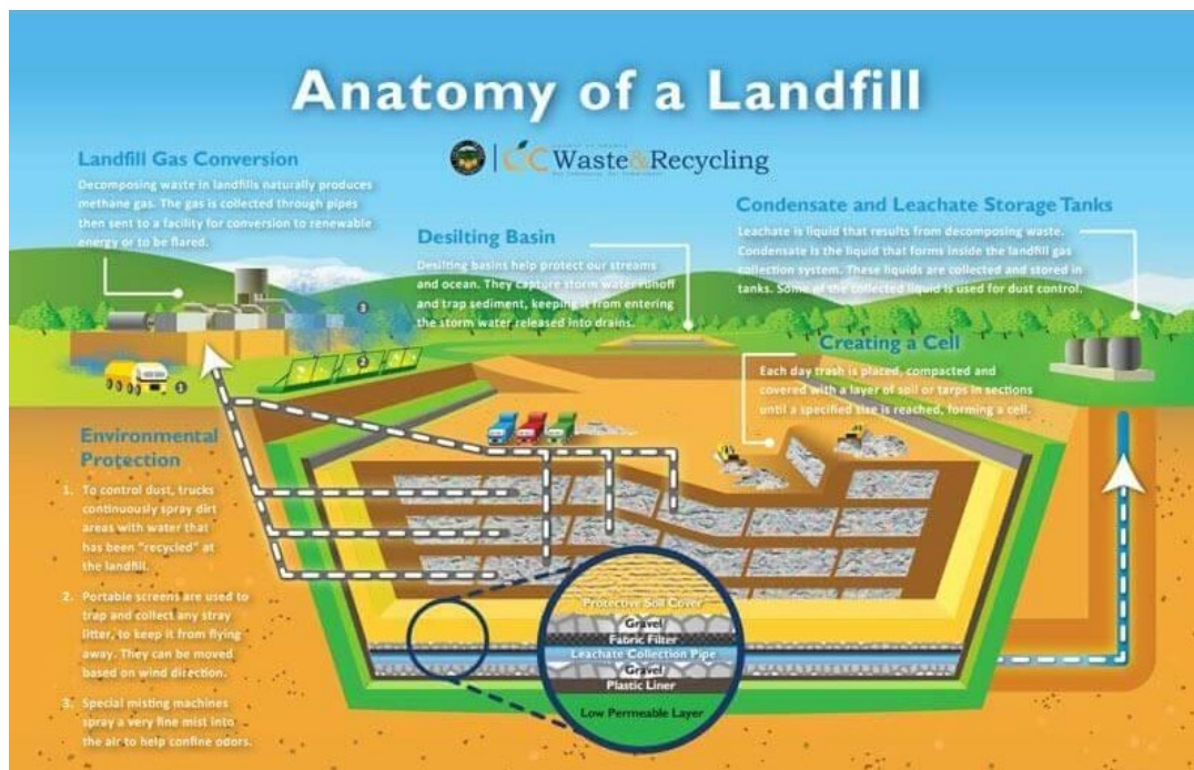
Figuur 10: Typische doorsnede van een moderne sanitaire stortplaats (Bron: https://www.baltimorecountymd.gov/departments/publicworks/recycling/theresource/today-s-landfill-not-your-grandpa-s-dump ).
